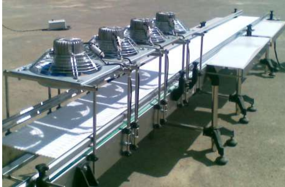
نقاله عریض مجهز به سامانه خشک کن و میز کار در طرفین
